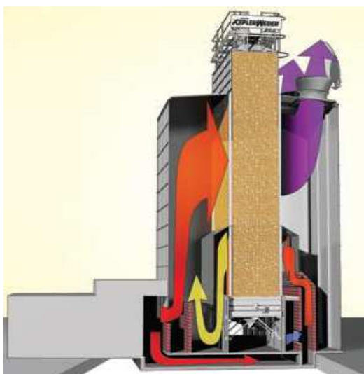
Схема распределения воздуха в сушильной колонне
